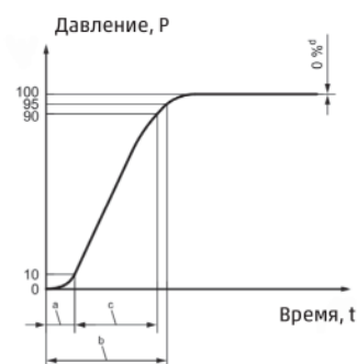
Переходный процесс без колебаний (апериодический)
